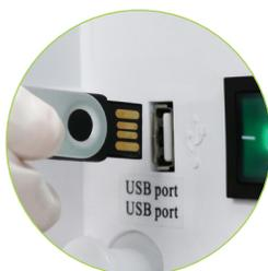
L'appareil est équipé d'une interface USB 2.0 standard. Les données sont automatiquement enregistrées sur la clé USB à la fin de chaque cycle.
